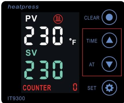
Appuyer simultanément sur les deux flèches pendant 8 secondes.
