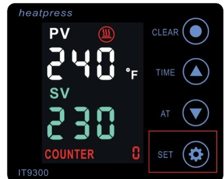
La température mesurée sur l'écran augmente de 10 degrés et commence à se refroidir jusqu'à la température correcte.
