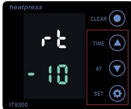
Si la température mesurée à l'aide de la bande est trop froide de 10 degrés, ajuster le chiffre avec -10. Appuyez ensuite à nouveau sur la touche SET.
