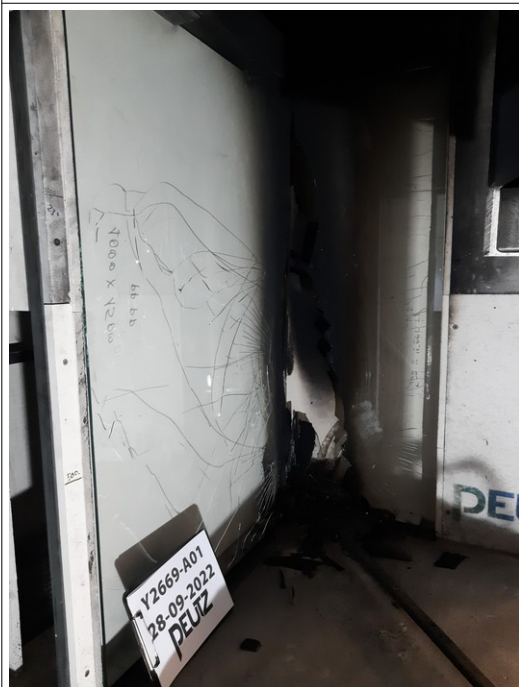
Proefstuk na afloop SBI test
