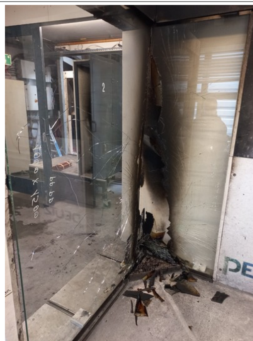
Proefstuk na afloop SBI test
