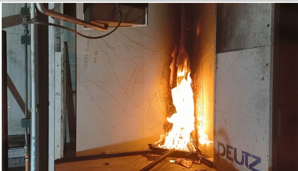
Proefstuk tijdens de SBI test (na ca. 15 minuten)
