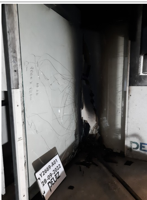
Proefstuk voorafgaand aan SBI test
