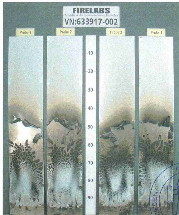
Bild 4 Aussehen der Probekörper nach dem Brandversuch
